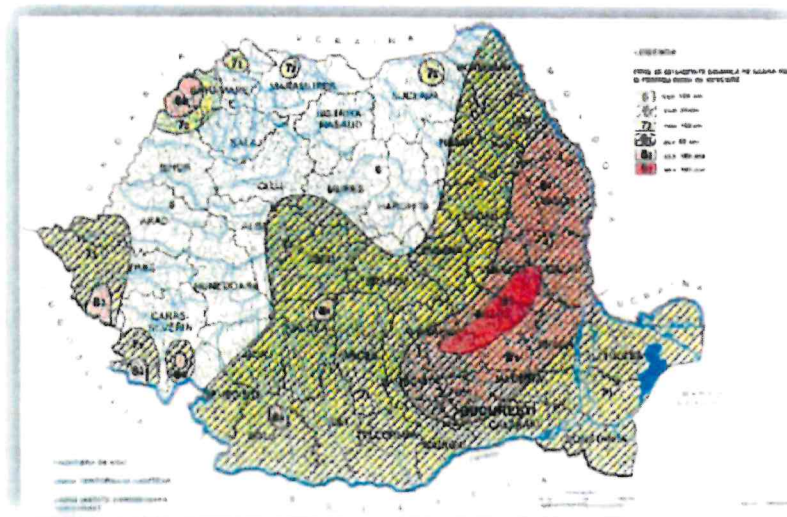
Figura 2 Zonarea seismica a teritoriului Romaniei
